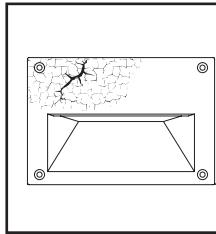
**ITA.** Alte temperature ambientali provocate da condizioni climatiche estreme o da altre fonti di calore riducono la durata e l'efficienza della componentistica o del modulo LED.
