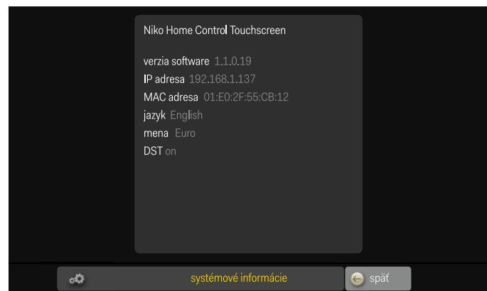
Obrazovka zobrazuje nastavenie jazyka, mena a DST (letný čas). Cez túto obrazovku nemôžete toto nastavenie zmeniť. Tento typ systémových informácií môže zmeniť iba inštalatér pomocou programovacieho softvéru.
