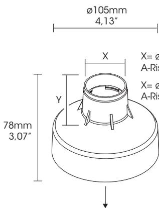
X=  $\varnothing 41\text{mm}/\varnothing 1,61''$  Y=  $30\text{mm}/1,18''$
