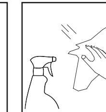
**ITA.** Pulire periodicamente gli apparecchi per rimuovere gli accumuli di sporco. Pulire le parti in acciaio utilizzando appositi detergenti. Per la pulizia dell'apparecchio utilizzare un panno morbido umido con sapone neutro.
