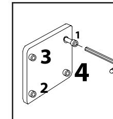
**ITA.** Bloccare e sbloccare le viti di chiusura con sequenza alternata.
