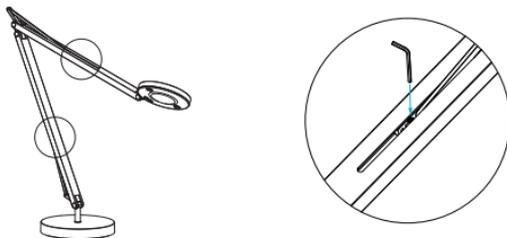
Das Kopfgeelenk kann über eine kleine Schraube nachjustiert werden. Nehmen Sie dafür vorsichtig die Abdeckscheibe am Gelenk ab und ziehen Sie mit dem Inbusschlüssel die Schraube leicht an. Stecken Sie anschließend die Abdeckscheibe wieder auf das Gelenk.
