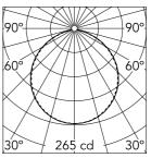
Luminous flux luminaire 714 lm
