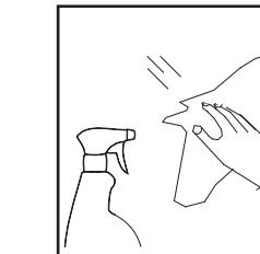
**IT.** Pulire periodicamente gli apparecchi per rimuovere gli accumuli di sporco che si depositano sulle griglie e nella testa delle viti. Pulire le parti in acciaio utilizzando appositi detergenti. Per la pulizia dell'apparecchio utilizzare un panno morbido e detergente neutro.
