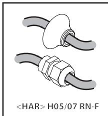
**IT.** Utilizzare un cavo di alimentazione con tipologia idonea (cavi flessibili HAR H05/07 RN-F o idonei per l'utilizzo all'esterno); i cavi rigidi possono compromettere la tenuta attraverso il pressacavo/passacavo.
