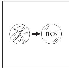
**IT.** Sostituire il vetro/diffusore con ricambio originale FLOS in caso di rottura.
