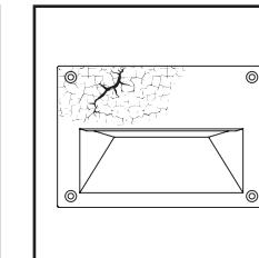
**IT.** Durante il montaggio e la manutenzione degli apparecchi è necessario prestare particolare attenzione a non danneggiare la verniciatura a polvere. Un danno combinato all'azione dell'acqua potrebbe provocare la corrosione. I prodotti chimici danneggiano la protezione anticorrasione.
