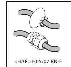
**IT.** Utilizzare un cavo di alimentazione con tipologia idonea (cavi flessibili HAR H05/07 RN-F o idonei per l'utilizzo all'esterno): i cavi rigidi possono compromettere la tenuta attraverso il pressacavo/passacav.
