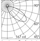
Luminous flux luminaire 523 lm
