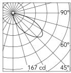
Luminous flux luminaire 523 lm
