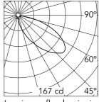
Luminous flux luminaire 523 lm
