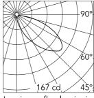
Luminous flux luminaire 523 lm
