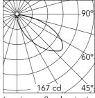
Luminous flux luminaire 523 lm
