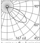
Luminous flux luminaire 523 lm
