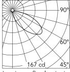
Luminous flux luminaire 523 lm
