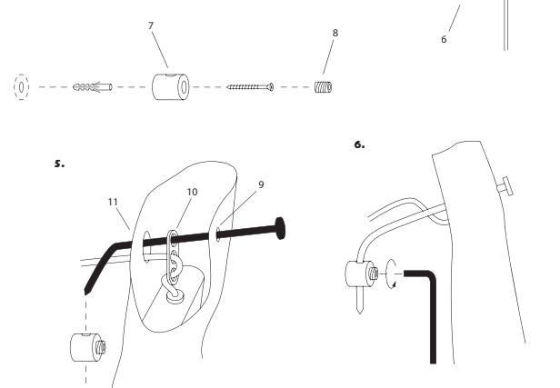
7. Montage des Gewichts / Assembly of weight / Montaggio contrappeso / Montage du poids
