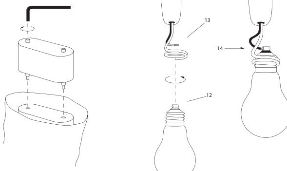
8. Montage der Leuchtmittel / Installation of bulbs / Inserimento lampadina / Montage de l'ampoule
