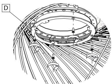
**ES** En la estructura superior (I) introducir el disco de suspensión (D) y fijarlo utilizando 4 tornillos. Pasar los cables suspendidos.
