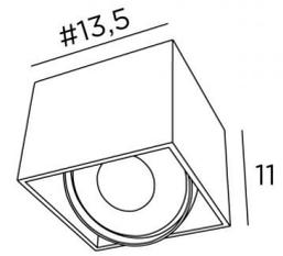
Plafonnier avec un spot pour ampoule Ø111mm (AR111-12V). Existe avec l'ampoule fixe et moins de hauteur
