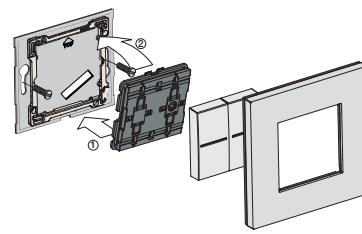
V už existujúcej inštalácii je možné ZVISLE rozšíriť spínač na dvojitý spínač pomocou zvislého dvojtého rámčeka so stredovou vzdialenosťou 71mm.
