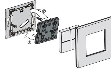
Wenn Sie einen bereits montierten Schalter in einer vorhandenen Anlage vertikal zu einem 2-fach-Schalter **ERWEITERN** möchten, verwenden Sie hierzu bitte einen zweifach vertikalen Abdeckrahmen mit Mittenmaß 71mm. Der **AUSTAUSCH** eines in einer Einbaudose für Schraubbefestigung montierten Schalters ist möglich, wenn die Schrauben horizontal liegen.
