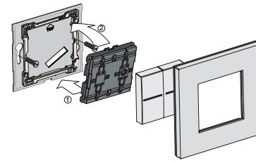
Als u in een bestaande installatie een reeds geplaatste schakelaar verticaal wil **UITBREIDEN** tot een tweevoudige, gebruik hiervoor dan een tweevoudige verticale afdekplaat met centerafstand 71mm. U kan een bestaande schakelaar, geplaatst in een inbouwdoos voor Schroefbevestiging, **VERVANGEN** op voorwaarde dat de schroeven horizontaal geplaatst zijn.
