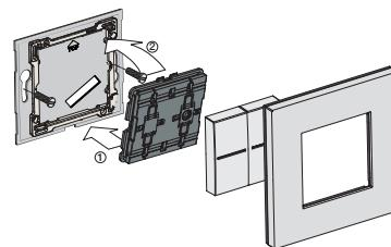
Si dans une installation existante, vous souhaitez **AJOUTER** (verticalement) un émetteur à un interrupteur déjà placé, utilisez une plaque de recouvrement double verticale entraxe de 71mm.
