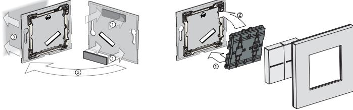
**2. Vissage:** sur une surface structurée comme des murs en pierre, du plâtre...
