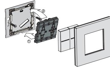
Vinkel **UTBYGGNAD** av en strömkontroll i en befintlig installation till en dubbel strömkontroll är möjligt med hjälp av en dubbel vinkel täckplatta med 71 mm från mittpunkt till mittpunkt.
