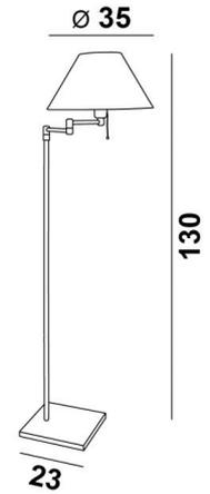
Liseuse avec bras articulé et abat-jour rond conique. Interrupteur-tirette installé sur la douille E27.
