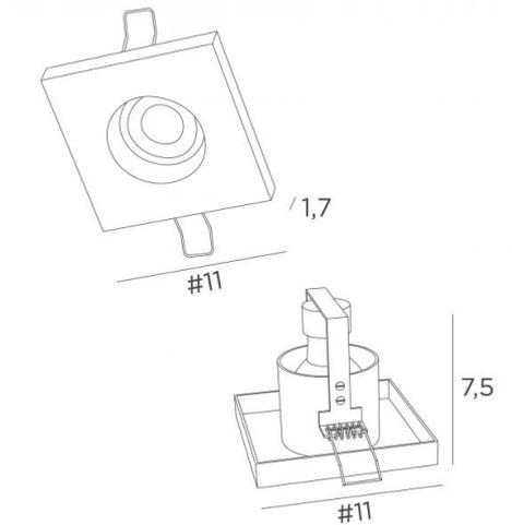
ORLANDO est un spot-plafond à encastrer dont l'ampoule GU10 est intégrée dans un boîtier carré tout en épaisseur
